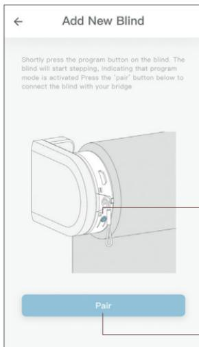
Drücken Sie kurz auf die Programmtaste am Motor
