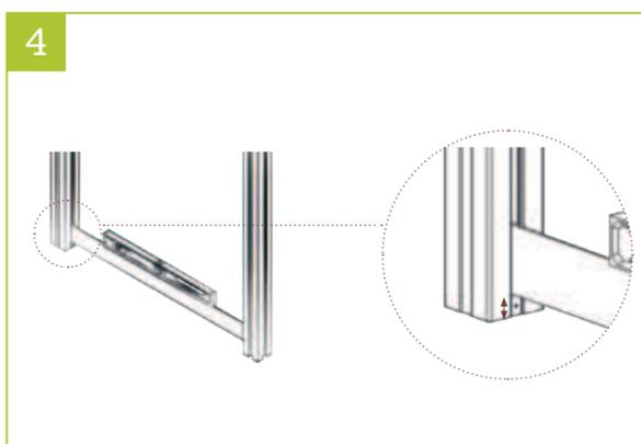
4 | Zuerst auf einer Seite das Distanzstück befestigen. Das Distanzstück der zweiten Seite mit Hilfe eines Füllungselementes und einer Wasserwaage ausrichten und befestigen.
