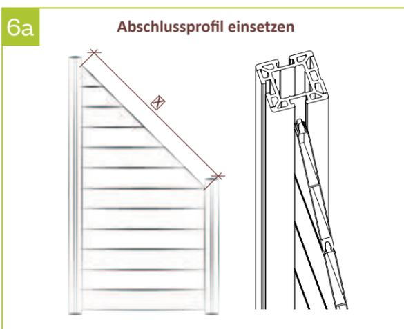
6a | Messen Sie die oben angegebene Länge. Bitte messen Sie immer von der Innenkante bis zur Innenkante des Pfostens!
