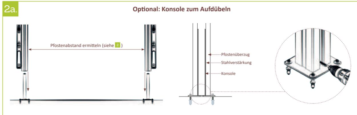
2a | Ausrichtung der Konsolen bei aufgesteckten Pfosten, danach aufdübeln. Der Pfostenüberzug und die Stahlverstärkung schließen nach dem Aufsetzen des Pfostens bündig ab.\*
