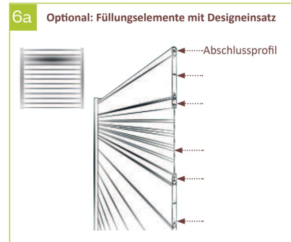
6a | Die Füllungselemente nacheinander von oben einschieben, dabei die Feder der Füllungselemente nach oben ausrichten. Bei der Montage des Designeinsatzes folgende Reihenfolge beachten: Adapterprofil mit Nut, Designelement, Adapterprofil mit Feder. Danach ein Füllungselement einschieben und das Abschlussprofil aufsetzen.
