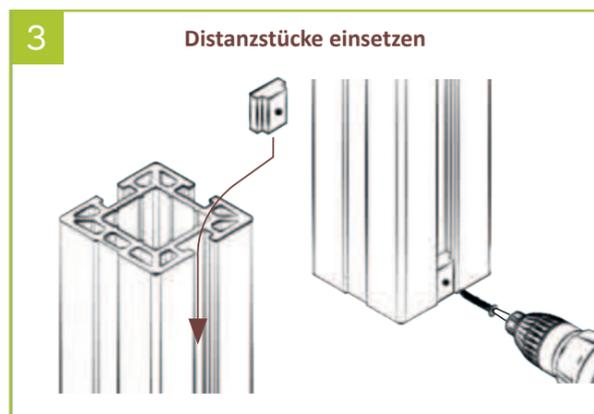
3 | Distanzstück hochkant in die Innenseite der Pfostennut einschieben, bündig mit der Unterkante des Pfostens abschließen, vorbohren und verschrauben.
