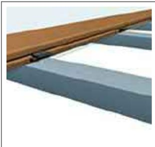
Installieren Sie nun Terrassendiele für Terrassendiele mittels WPC Befestigungsclips seitlich in den Nuten und den Clip auf der Unterkonstruktion mit einer Schraube. Auch hier das Vorbohren nicht vergessen. Wiederholen Sie diesen Vorgang bis Sie zur letzten Terrassendiele gelangen.
