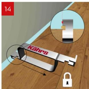
Bei Bedarf können die Dielen in jede Richtung verlegt werden. Woodloc® 5s ist zudem leicht wieder deinstallierbar. Verwenden Sie zum Öffnen den Schieber (mit der Langen Nut) in der gleichen Art und Weise wie beim Schließen der Dielenverbindung. Ziehen Sie den Schieber zu sich heran und öffnen Sie so den Verschluss. Die Dielen sind dann ganz einfach aufzunehmen.
