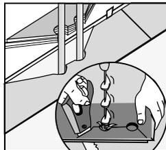
Schneiden Sie die Diele im 45°-Winkel zur Öffnung ab. Das ausgeschnittene Stück wird dann wieder in die Position geklebt. Bedecken Sie die Öffnung mit einer Rohrhülse.
