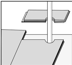
Bohren Sie in die Dielen die erforderlichen Aussparungen. Falls die Rohre durch den Boden verlaufen, schneiden Sie eine Öffnung aus der Diele heraus, die mindestens 10mm größer als der Durchmesser des Rohrs sein sollte.
