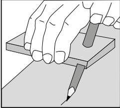
Übertragen Sie die Kontur der Wand auf die Dielen. Halten Sie einen Abstand von 5mm zur Wand für die Dehnungsfuge ein.
