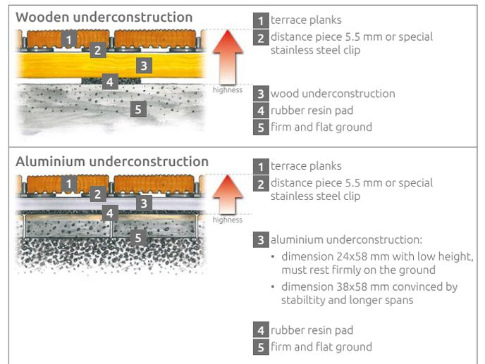
Hinweise: Immer auf eine ausreichende Unterlüftung achten. Zu festen Bauteilen sollte ein Abstand von 2 cm gehalten werden! Gummigranulatpads unter die Unterkonstruktion legen.
