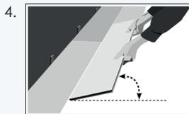
4. Der **HC KORK-FERTIGPARKETT** wird üblicherweise nicht geleimt, sondern trocken verlegt. Dabei werden die einzelnen Dielen mit der Feder der Langkante in die Nut der davor liegenden Diele in einem Winkel von 20-30° eingedreht, indem man die Diele auf und ab bewegt. Die Langkante kann zusätzlich mit der **KWG Schlagleiste (Art.-Nr.: 840030)** zusammen geklopft werden. Bitte achten Sie vor der Verlegung darauf, dass Nut und Feder frei von Spänen oder sonstigen Verunreinigungen sind.
