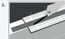
6. Die letzte Dielenreihe wird in die richtige Breite gesägt. Dabei ist auf die Dehnungsfuge zu achten! Danach wird die Dehnungsfuge mit einer Fußleiste abgedeckt. Sie darf allerdings nicht zu dicht auf dem **HC KORK-FERTIGPARKETT** liegen, um die Bewegungsfreiheit des Bodens nicht zu beeinträchtigen.
