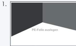
1. Es ist zu empfehlen an einer geraden Wand, längs zum Lichteinfall, von rechts nach links zu beginnen. Eine Dampfsperre ist bei allen mineralischen Untergründen unerlässlich. Legen Sie dazu eine mindestens 0,2 mm starke PE-Folie unter den **HC KORK-FERTIGPARKETT**, wobei die Stoßkanten ca. 20 cm überlappen und abgeklebt werden müssen. An den Wänden ist die Folie ca. 3 cm hochzuziehen. Wir empfehlen Ihnen die Übergänge mit einem Klebeband abzukleben.
