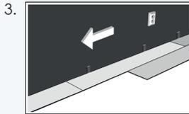
3. Bei den Dielen der ersten Reihe wird die Feder der Langkante mit einer geeigneten Säge abgeschnitten, so dass die Schnittkante zur Wand zeigt. Die folgenden Dielenreihen sollen mind. 1/3 versetzt verlegt werden. Optimal ist die Verlegung im Halbverband (mind 30 cm).
