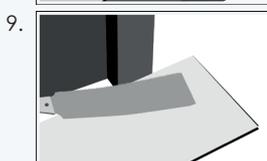
9. Feste Bauteile wie Tüzzargen müssen gekürzt werden, damit das **HC KORK-FERTIGPARKETT** darunter liegen kann. Es darf nicht anstoßen. Vor der Kürzung der Tüzzarge muß geprüft werden, dass die Tüzzarge dauerhaft befestigt ist. Ein Absacken der Tüzzarge könnte die Bewegungsfreiheit des **HC KORK-FERTIGPARKETT** beeinträchtigen. Aufgrund dessen sollte auch auf eine Silikonfuge verzichtet werden!
