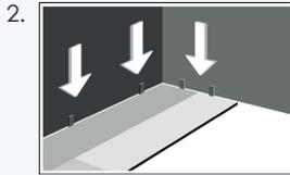
2. Eine Dehnfuge von mind. 10 mm zwischen dem **HC KORK-FERTIGPARKETT** und der Wand sowie allen festen Bauteilen wie Heizungsrohre, Tüzzargen usw. muss zwingend eingehalten werden. Raumlänge bis 10 m = 10mm Dehnfuge; bei einer Raumlänge ab 10 m je weiteren Meter 1 mm Dehnfuge zusätzlich einhalten (maximale Raumgröße 15 m Länge und 10 m Breite).
