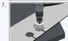
7. Für Rohranschlüsse werden Löcher gebohrt, deren Durchmesser ca. 20 mm größer sind, als der des Rohres. Nachdem die Diele verlegt ist, wird das Reststück eingesetzt. Die Abdeckung erfolgt nachträglich mit Rosetten.
