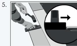
5. Zum Zusammenfügen der Kurzseite schlagen Sie diese mit der **KWG Schlagleiste (Art.-Nr.: 840030)** an der Nutseite vorsichtig ineinander. Schlagen Sie nie die Federseite, da diese sonst beschädigt werden kann. Bei zu starkem Zusammenklopfen kann sich die Korkauflage im Kantenbereich hochdrücken. Für die letzte Diele in einer Reihe benötigen Sie ein Zugeisen zum Zusammenfügen.
