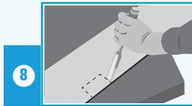
Ausklinkungen können mittels Säge und Stecheisen vorgenommen werden.
