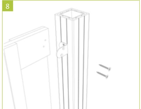
8 | Nach der Befestigung aller Elementhalter wird das Zaunelement mit jeweils zwei selbstschneidenden Schrauben  $\text{\O} 3,9 \times 19 \text{ mm}$  pro Elementhalter befestigt. Es wird empfohlen, die Schraubenlöcher mit einem 3 mm Bohrer vorzubohren! Die Elementhalter werden von hinten an den Aluminiumquerträgern befestigt.
