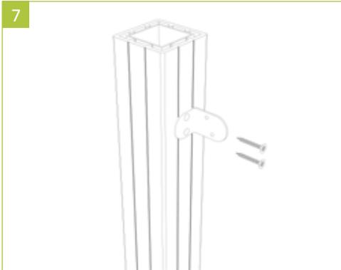
7 | Die Elementhalter mit zwei selbstschneidenden Schrauben  $\text{\O} 3,9 \times 25 \text{ mm}$  am Pfosten befestigen. Es wird empfohlen, die Schraubenlöcher mit einem 3 mm Bohrer vorzubohren! Den Halter entsprechend der auf der vorigen Seite dargestellten Übersichtszeichnung an dem Pfosten ausrichten, so dass diese später mittig auf den Aluminiumquerriegeln sitzen! Es wird empfohlen, die Elementhalter an der Rückseite anzubringen, so dass die Halter später von vorne nicht zu sehen sind!
