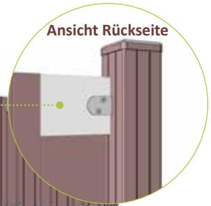
Die Zaunelementhalter dienen zur Befestigung der einzelnen Zaunelemente an den Pfosten. Hierzu die Halter mit je zwei selbstschneidenden Schrauben ( $\text{\O} 3,9 \times 25 \text{ mm}$ ) am Pfosten und je zwei selbstschiebenden Schrauben ( $\text{\O} 3,9 \times 19 \text{ mm}$ ) an den Querriegeln der Zaunelemente befestigen. Die Elementhalter entsprechend der obigen Zeichnung an den Aluminium-Querriegeln anbringen (siehe Skizze).
