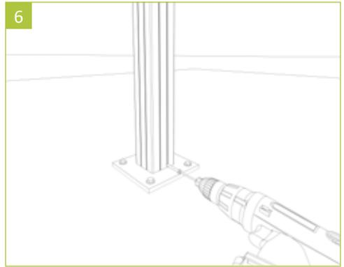
6 | Die Pfosten anschließend über die Konsolen stecken und mit zwei Blechschrauben gegenüberliegend, die quer am unteren Pfostenrand eingeschraubt werden, sichern. Wir empfehlen die Löcher mit einem Metallbohrer vorzubohren.
