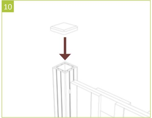
10 | Nach der Befestigung der Zaunelemente abschließend die Pfostenkappen auf die Zaunpfosten aufstecken.
