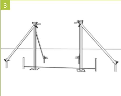
3 | Die Pfosten mit Holzleisten und Schraubzwinde zum nachfolgenden Einbetonieren abstützen. Zwischen Schraubzwinde und Pfostenoberfläche kleine Hölzer legen, um Kratzer zu vermeiden! Nochmalige Kontrolle des korrekten Pfostenabstands und der senkrechten Ausrichtung!
