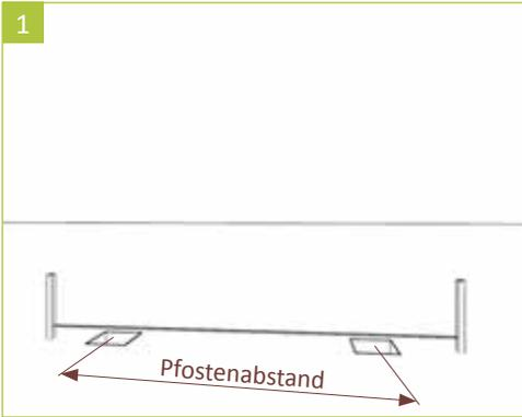
1 | Nach der Planung des Zaunverlaufs diesen mittels einer Richtschnur und Holzpfosten festlegen. Hierbei unbedingt den Höhenverlauf des Geländes berücksichtigen. Das Ausheben der Pfostenlöcher erfolgt mit einem Spaten. Die Löcher ca. 300 x 300 mm groß und je nach Bodenbeschaffenheit mindestens 500 mm tief anlegen.
