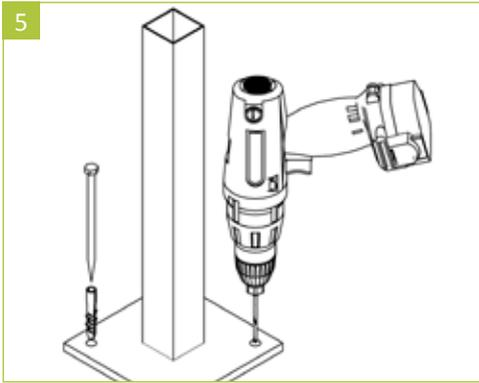
5 | Alternativ können bei bauseits vorhandenem Betonfundament oder Mauersockel Konsolen zum Aufschrauben Verwendung finden. Diese werden identisch wie beim Betonieren ausgerichtet und mit einer geeigneten Schrauben-/Dübelkombination befestigt.
