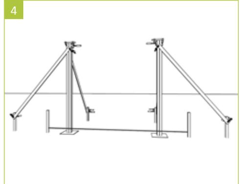
4 | Fertig- oder Estrichbeton in erdfeuchtem Zustand in die Erdlöcher füllen. Den Beton mit einem Kantholz verdichten! Zwischendurch immer wieder den korrekten Stand der Pfosten kontrollieren! Abschließend verbliebende Betonreste mit etwas Wasser von den Pfosten entfernen! Den Beton laut Packungsangabe (mind. 24 Std.) abbinden lassen. Die Pfosten bis zum Abbinden des Betons abstützen.
