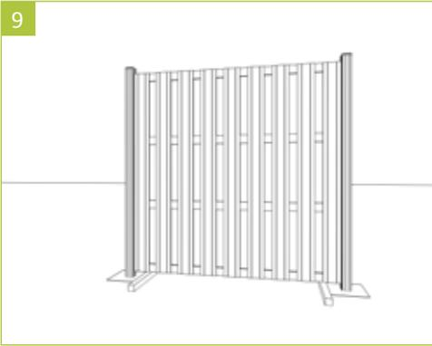
9 | Zur leichteren Montage der Zaunelemente wird empfohlen, unter diese ca. 30 mm hohe Hölzer als Abstandshalter während des Aufbaus unterzulegen. Diese werden nach der Befestigung der Zaunelemente wieder entfernt.
