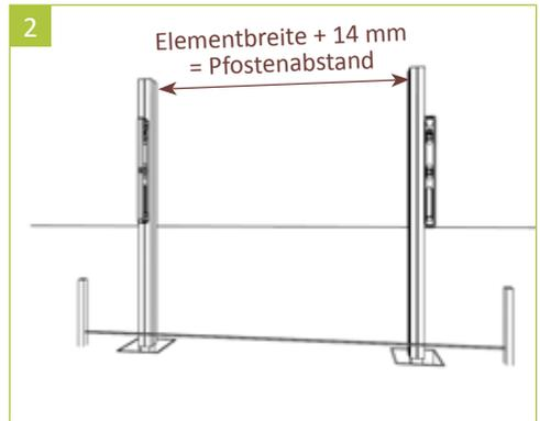
2 | Die Pfosten mit der herausragenden Stahlverstärkung nach unten in die Fundamentlöcher setzen und mit einer Wasserwaage ausrichten (von zwei Seiten, 90° versetzt). Den Pfostenabstand entnehmen Sie bitte aus der Elementübersicht. Die Oberkanten der Pfosten mit der Wasserwaage auf die gleiche Höhe ausrichten.
