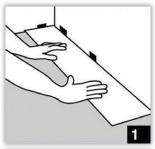
Legen Sie die erste Diele in die Ecke des Raumes, so dass die Nase der Klickverbindung zu Ihnen zeigt und die Rückseite der Diele zur Wand. Der Abstand von der Diele zur Wand soll 10-15 mm betragen und wird nach der Verlegung mit einer Sockelleiste überdeckt. Tipp: Den Abstand können Sie mit Keilen schaffen.
