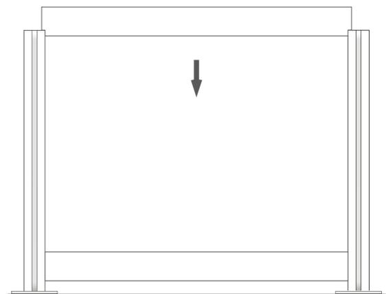
Anschließend die Profile nacheinander von oben in den Pfosten einsetzen.
