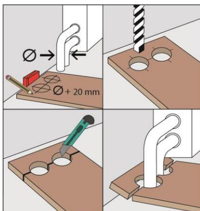
Wo beispielsweise Heizungsrohre aus dem Boden ragen, bitte zuerst das Paneel auf die richtige Länge zuschneiden, dann das Paneelstück neben den eigentlichen Platz legen und die Aussparungen mit dem Zollstock abmessen und anzeichnen. Auch hier bitte immer an den mind. 10 mm umlaufenden Abstand der Dehnungsfuge denken. Nun können Sie die markierten Stellen ausbohren. Anschließend sägen Sie das Paneel zu. Anschließend hinter dem Heizungsrohr platzieren und mit dem Paneel wieder dicht zusammenfügen.
