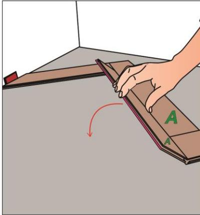
Beginnen Sie nun mit der zweiten Reihe, in dem Sie die A-Planke an die A-Planke der ersten Reihe klicken. Drücken Sie hierzu kopfseitig runter, damit die Clickverbindung vollständig einrastet.
