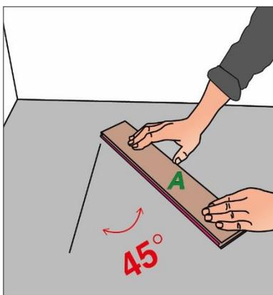
Die Verlegung startet in einer linken Ecke. Fangen Sie mit einer A-Diele an. Die schwarz markierte Seite sollte im 45 Grad Winkel zur linken Wand zeigen. Der Abstand zwischen der Wand und Dielenscheibe sollte nicht größer als die Länge einer Planke sein.
