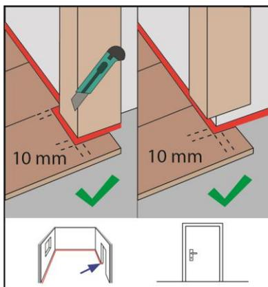
Türzargen aus Holz können gekürzt werden. Legen Sie dazu ein Paneel mit der Dekorseite nach unten gegen die Zarge. Kürzen Sie nun mit einer geeigneten Säge entlang des Paneels die Türzarge. Danach lässt sich die Paneele einfach mit der Dekorseite nach oben unter die Zarge schieben. Bei Türzargen, die nicht gekürzt werden können, schneiden Sie das Paneel entsprechend zu und beachten Sie die den mind. 10 mm umlaufenden Abstand der Dehnungsfugen.
