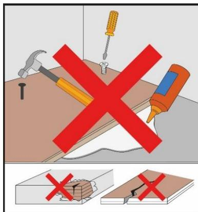
Trotz regelmäßiger Qualitätskontrollen sind Materialfehler nicht ganz auszuschließen. Bitte überprüfen Sie vor der Verlegung die Bodenbeläge auf Chargengleichheit (optische Gleichheit) und Fehler bzw. Schäden. Erkennbare Mängel können wir nach Verlegung oder Zuschnitt nicht mehr anerkennen. Beachten Sie, dass der Bodenbelag nicht geschraubt, geklebt oder genagelt werden darf.
