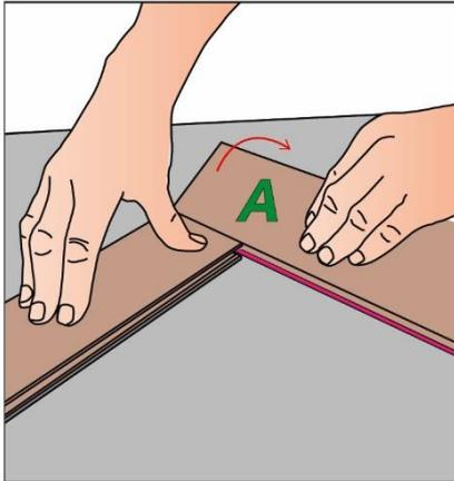
Fahren Sie fort, indem Sie die Längsseite einer weiteren A-Planke an das kurze Ende der B-Diele klicken. Machen Sie mit den A- und B-Planken solange weiter, bis die erste Reihe vervollständigt ist.
