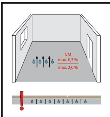
Überprüfen Sie die Feuchtigkeit des Unterbodens. Die maximal zulässige Feuchte bei Zementestrich liegt bei 2,0%, bei Fußbodenheizung 1,8%. Bei Anhydrit-(Calciumsulfat)-Estrich liegt die maximale Restfeuchte bei 0,5%, bei Fußbodenheizung max. 0,3%.
