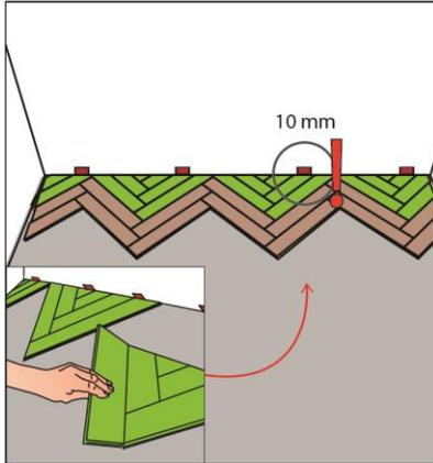
Nun können Sie die Planken (im Bild grün markiert) an die Wand legen. Wenn Sie die Variante 1 verwendet haben, müssen Sie die zugeschnittenen Planken als Dreiecke von links nach rechts legen. Wir empfehlen die kleineren Teile der Dreiecke an den Click-Verbindungen zu kleben. Bitte beachten Sie den Abstand von mind. 10 mm zur Wand.
