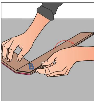
Fahren Sie mit einer B-Planke fort, indem Sie die Längsseite der B-Diele an das kurze Ende der A-Diele klicken. Achten Sie darauf, dass die Dielen absolut bündig zueinander liegen.
