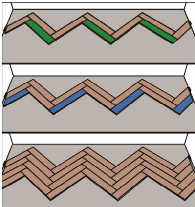
Klicken Sie von links nach rechts alle weiteren A-Planken an die erste Reihe. Anschließend klicken Sie von rechts nach links alle weiteren B-Planken. Hierzu kopfseitig herunterdrücken bis diese vollständig einrastet. Schneiden Sie links und rechts die entsprechenden Planken in die entsprechende Länge zu. Dies solange fortführen bis Sie vier Reihen geklickt haben.
