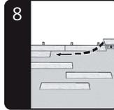
6. Rasten Sie die Diele dann eng an der ersten Reihe (lange Seite) mit einem Einbringwinkel von 10-20 Grad ein. Die zweite Diele verbinden Sie durch Einrasten an der langen Seite und anschliessendes Schieben zur kurzen Seite der ersten Diele. Üben Sie dann einfach einen leichten Druck aus. Siehe Abbildung 6. Verwenden Sie gegebenenfalls auch einen Schlagklotz und einen Gummihammer an den langen Seiten um sicherzustellen, dass die Diele eng miteinander verbunden sind. Siehe Abbildung 7.
