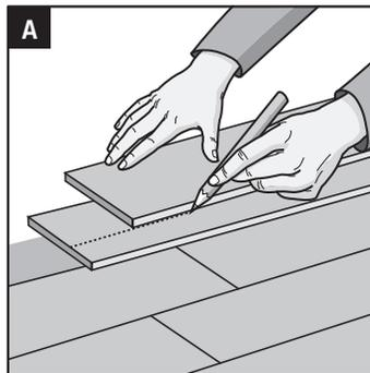
1. Verlegen Sie zunächst eine Reihe loser Paneele, ohne sie miteinander zu verbinden. Prüfen Sie, ob Sie die Länge des ersten Paneels anpassen müssen, um ein kleines Stück von weniger als 30 cm an der gegenüberliegenden Wand zu vermeiden. Oder messen Sie die Raumlänge und dividieren Sie sie durch 121 cm (die Länge eines Paneels). Wenn der Rest weniger als 30 cm beträgt, kalkulieren
