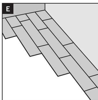
**TIPP 6:** Wenn Sie ein Paneel von planeo Rigid Klick Vinylboden für den Beginn der Reihe zurechtschneiden, müssen Sie das Ende mit der weissen Schliessleiste für eine Verlegung von links nach rechts sowie für eine Verlegung von rechts nach links abschneiden. Das Reststück kann dann auf der gegenüberliegenden Raumseite am Ende dieser Reihe verwendet werden, soweit die Raumaufteilung dies gestattet.
