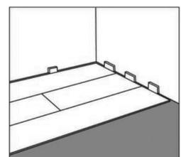
6. Schneiden Sie die Diele auf die benötigte Breite zu. Legen Sie die erste Diele auf die zweite Reihe und schneiden Sie diese wie beschrieben zu. Der Abstand zur Wand sollte 5 bis 10 mm betragen, damit sich der Boden bewegen kann.
