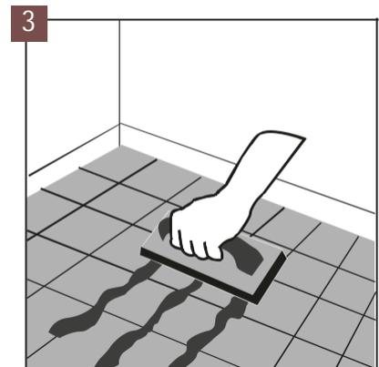
3 Bei der Verlegung auf keramischen Fliesen soll die Fugenbreite nicht mehr als 4 mm und die Tiefe nicht mehr als 1 mm betragen. Größere Abstände sind mit Harzmasse auszufüllen. Der Boden kann auf Fliesen mit Fugen mit einer Breite von bis zu 5 mm und einer Tiefe von 1 mm ohne deren Ausgleich verlegt werden, unter der Voraussetzung, dass die Unterlage planeo Silence (125611) verwendet wird.
