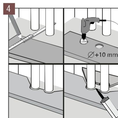
Bei Heizanlagen mit mehreren Elementen wird ähnlich vorgegangen. Zugeschnittene Paneel teile sind mit geeignetem (für Kunststoff) Klebstoff verbunden werden.
