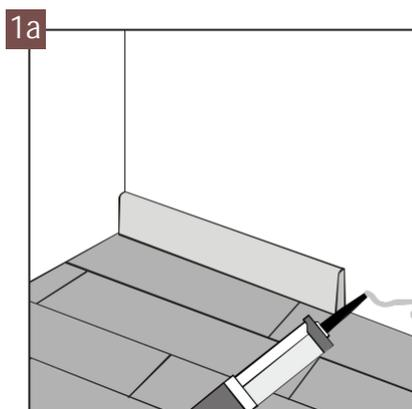
Dehnungsfugen entlang den Wänden sollen mit passenden anhand von Klebstoff oder Clips montierten Sockelleisten zugedeckt werden.
