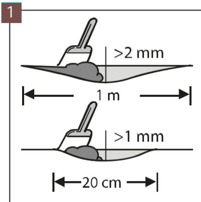
Stellen Sie sicher, dass der Untergrund eben ist. Eine Unebenheit von mehr als 1 mm über eine Länge von 20 cm muss ausgeglichen werden. Das Gleiche gilt für Unebenheiten von mehr als 2 mm über einer Länge von 1 m. Verwenden Sie eine geeignete Ausgleichsmasse und prüfen Sie, ob eine Grundierung oder ein Dichtmittel erforderlich sind. Um den Untergrund sorgfältig vorzubereiten ist die ganze Oberfläche mit selbstverlaufenden Ausgleichsmassen zu nivellieren.
