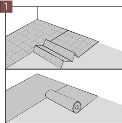
Verlegen Sie die planeo Silence (125611) quer zur Verlegerichtung der Paneele. Legen Sie die Nebenbahnen bündig aneinander an, lassen Sie sie überlappen oder verbinden Sie sie mit Aluband (10020602). Vermeiden Sie Abstände.
