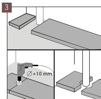
Rund um senkrecht laufende Röhre lassen Sie freien Raum. Der Durchmesser der Löcher für die Röhre muss um 15 mm größer sein als der der Röhre.
