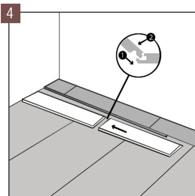
Die Bodenpaneele werden mit den Verschlüssen, die auf der kurzen und der langen Kante zu verbinden sind, versehen. Zuerst müssen die kurzen Kanten der Paneele miteinander verbunden werden.
