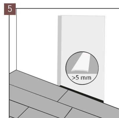
In folgenden Fällen ist in der Türöffnung zwischen den Räumen eine Dehnungsfuge von 5 mm zwecks Spannungsabbau anzuwenden: unregelmäßige Form des Fußbodens in benachbarten Räumen, schwere Möbel in einem der Räume, aktivierte Bodenheizung nur in einem der Räume im Objekt. Bei einer Fläche von über 200 m<sup>2</sup> und/oder länger als 20 m<sup>2</sup> ist eine 10 mm Dehnungsfuge notwendig.
