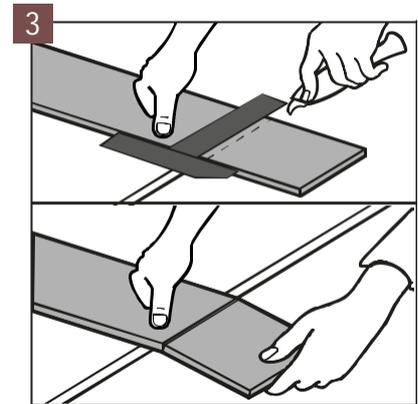
Verwenden Sie zum Zuschneiden der Bodenpaneele ein scharfes Messer, schneiden Sie die obere Schicht ein, danach knicken Sie energisch das Paneel nach unten weg. Die Bodenpaneele können auch mit einer elektrischen Säge zugeschnitten werden.
