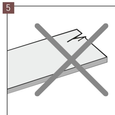
Vor und während der Verlegung sind sämtliche Paneele bei Tageslicht eingehend auf Beschädigungen und Materialfehler zu überprüfen. Paneele mit sichtbaren Mängeln oder Beschädigungen dürfen nicht verlegt werden. Bereits verlegte Dielen sind von der Reklamation ausgeschlossen.
