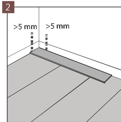
Lassen Sie zur Wand einen Abstand von ca. 5 mm. Die maximale Fläche, die ohne zusätzlichen Abstand zu verlegen ist, beträgt 200 m<sup>2</sup>. Bei der Verlegung in den größeren Räumen ist der zusätzliche Abstand einzuhalten sowie alle Abstände bis auf 10 mm zu vergrößern. Maximale Flächenlänge in einer Richtung, die ohne zusätzlichen Abstand zu verlegen ist, beträgt 20 m.
