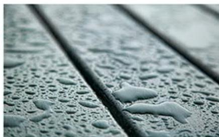
Durch die thermische Behandlung werden diejenigen Komponenten im Holz teilweise ausgetrieben, die Wasser besonders gut binden können. Dadurch herrscht im Thermoholz ein grundsätzlich niedriges Feuchtigkeitsrisiko. Für Holz zerstörende Pilze ist dieses relativ trockene Milieu nicht förderlich.
