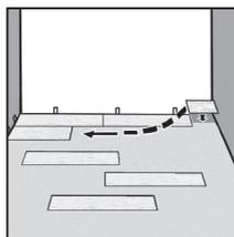
von 15-20 Grad ein. Das zweite Paneel verbinden Sie durch Einrasten an der langen Seite und Verwenden Sie gegebenenfalls auch einen Schlagklotz und einen Gummihammer an den langen Seiten um sicherzustellen, dass die Paneele eng miteinander verbunden sind. Siehe Abbildung E.
